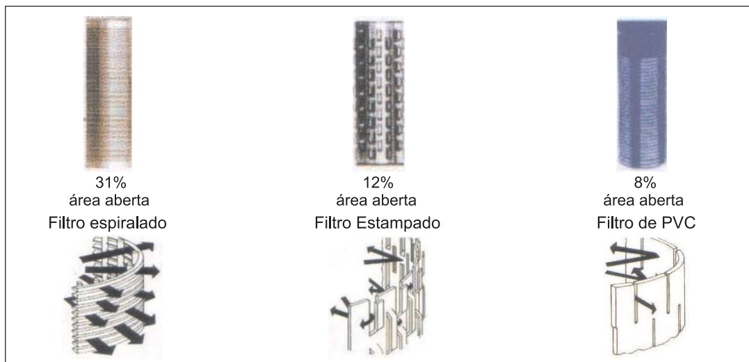
Figura 16.- Tipos de filtro e esquema de fluxo neles
