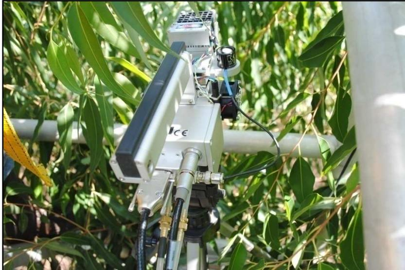
Figura 3 - Fotografia do aparelho analisador de gases do infravermelho (IRGA) constituído pela câmara foliar.
