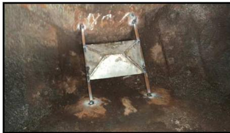
**Imagem 2** - Compensador de peso dentro da caixa de armazenagem de adubo do subsolador.
