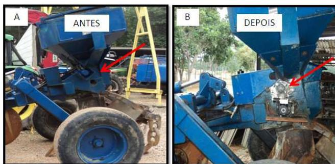
**Imagem 1** – Instalação do motor hidráulico. (A) Situação anterior. (B) Situação após alteração.
