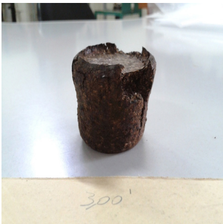
Figura 5. Briquete produzido com partículas grossas (acima de 0,500 mm) da torta de pinhão-manso a 200°C, apresentando rachaduras na superfície (Foto: Frederico Souza, 2012).
