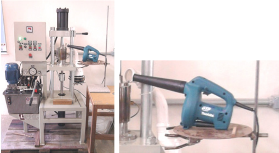
Figura 4. Prensa briquetadeira da marca Irmãos Lippel, modelo LB-32 onde se confeccionaram os briquetes. À direita em destaque o sistema de ventilação forçada para resfriamento (Fotos: Frederico Souza).
