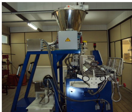
Figura 4. Sistema de extrusão dupla rosca Clextal Evolum HT25 (Firminy, França)
