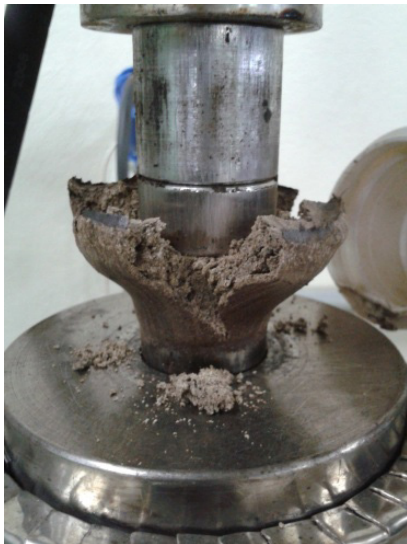
Figura 7. Briquete produzido com partículas abaixo de 0,500 mm da torta de pinhão-manso a 200°C, apresentando o esmagamento após expulsão do briquete na máquina briquetadeira (Foto: Frederico Souza, 2012).
