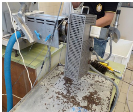
Figura 3. Sistema de extrusão monorosca 19/20DN acoplado ao reômetro de torque Do-corder DCE 330 (Duisburg, Alemanha).
