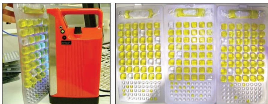
Figura 9. Leitura e Interpretação dos resultados da metodologia Colilert ( Standard Methods )
