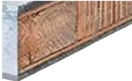
O miolo é formado por inúmeras lâminas de madeira revestido em ambos os lados por chapas de fibrocimento. As bordas recebem sarrafos maciços. Antigamente as placas cimentícias tinham amianto adicionado à sua composição, porém devido à restrições recentes ao uso deste material ele foi substituído por fibras sintéticas, inofensivas à saúde dos que o manuseiam.
