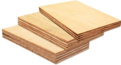
A resistência do laminado compensado depende da espécie de madeira utilizada, do tipo de cola, número de lâminas e espessura de cada uma. Na construção civil é muito utilizado para confecção de fôrmas para concreto e telhados.
