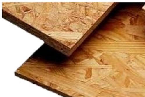
No Brasil geralmente são 4 camadas. Segue o princípio do compensado no qual as lâminas torneadas são dispostas perpendicularmente de acordo com a direção das fibras, mas no OSB se utiliza 96% da madeira, na forma de microlâminas, contra 56% do compensado o que permite otimizar o custo do produto, tornando-o ecologicamente mais eficiente.
