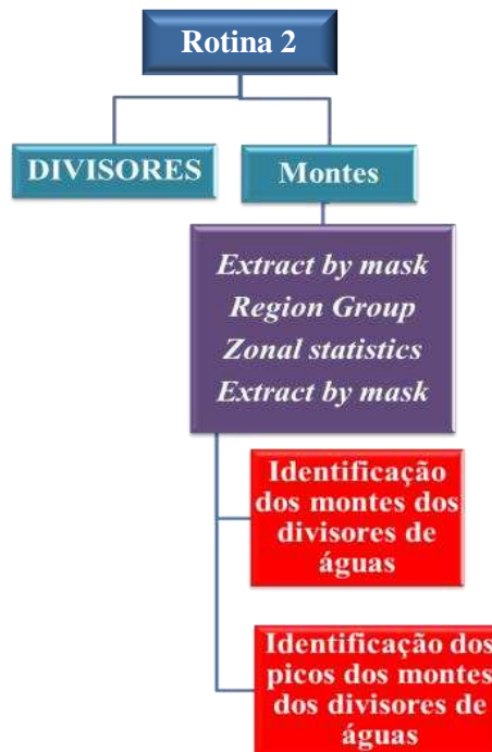
Figura 18 – Fluxograma da rotina 2. Nas caixas azul-claras encontram-se os principais e primeiros dados de entrada da sequência de operações em que estão envolvidos; nas roxas, as principais operações, nas alaranjadas, os resultados intermediários, e nas vermelhas, os resultados finais.
