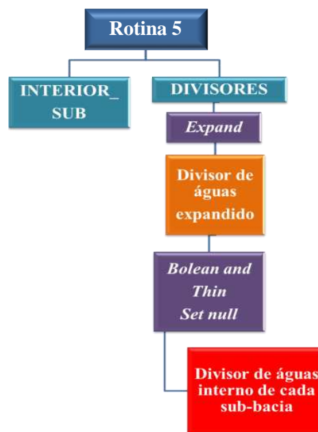
Figura 21 – Fluxograma da rotina 5. Nas caixas azul-claras encontram-se os principais e primeiros dados de entrada da sequência de operações em que estão envolvidos; nas roxas, as principais operações, nas alaranjadas, os resultados intermediários, e na vermelha, o resultado final.
