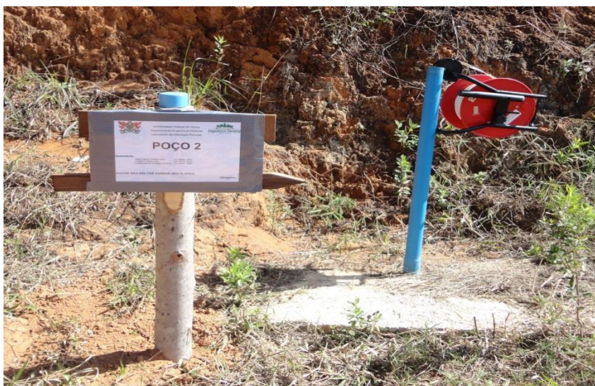
FIGURA 12: Poço piezométrico com o medidor de nível do lençol freático
