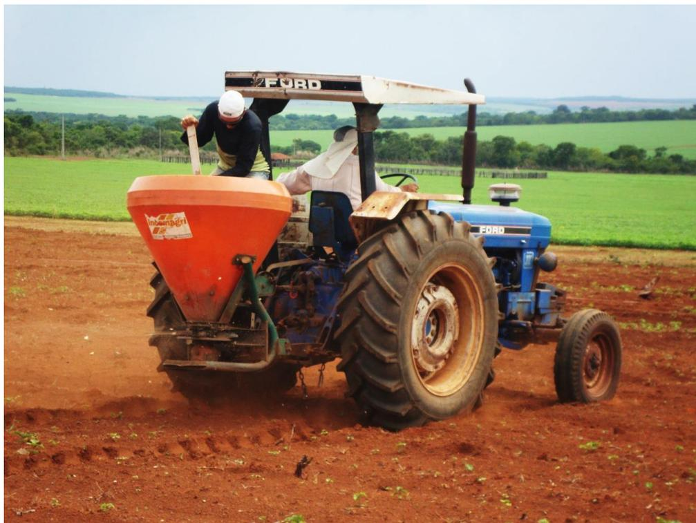
Figura 4: Trator e semeadora-adubadora no momento do plantio. Observa-se o técnico restaurador sobre a semeadora, revolvendo a “muvuca de sementes” para facilitar sua saída pelo fundo dosador regulável.
