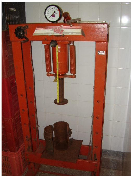
Figura 2. Prensa hidráulica utilizada para compactação das amostras de solo e suporte de aço para a acomodação dos tubos de PVC.
