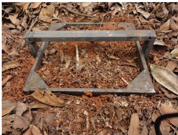
Figura 7. Amostra de solo a 5 cm de profundidade sendo demarcado pelo gabarito.
