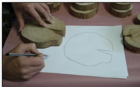
**Figura 4.** Contorno do disco da base na folha A4 para determinação da área das amostras da espécie de *Eucalyptus* sp.
