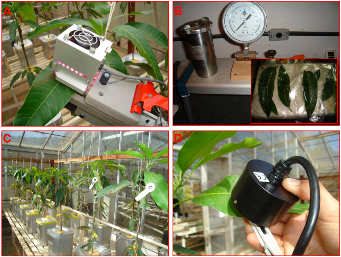
Foto 2 - Medição dos parâmetros de trocas gasosas com controle de temperatura e irradiância (A), potencial hídrico foliar (B), e fluorescência da clorofila (C e D) em mangueiras submetidas a estresse salino.
