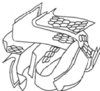
Figura 4 Representação esquemática da estrutura do carvão ativado Fonte: Rodríguez-Reinoso (1998 citado por COUTO, 2009)
