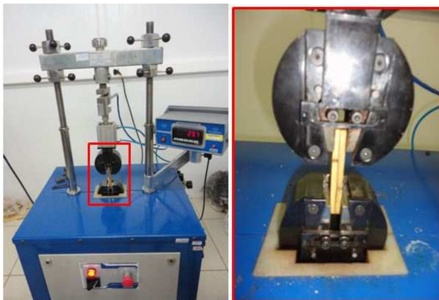
Figura 9 Máquina de ensaio utilizada para o teste de cisalhamento da linha de cola. Em detalhe a garra do equipamento
