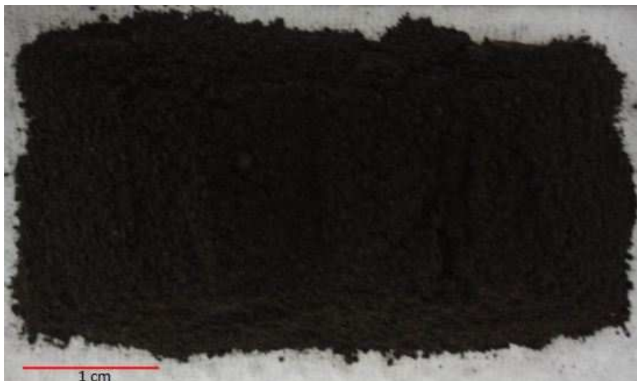
Figura10 Lignina Kraft utilizada na reação de síntese de adesivo fenólico. Cor bastante escura, classificada por Munsell Soil Color Company (1975), como Black
