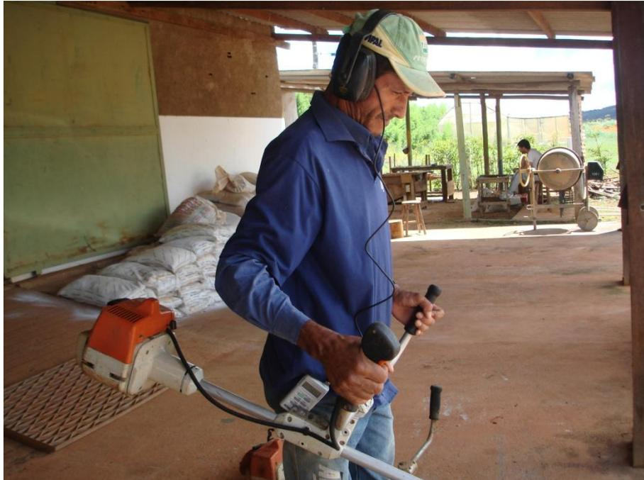
**Figura3** – Operador de roçadora usando um aparelho dosador para aferição do nível de ruído.
