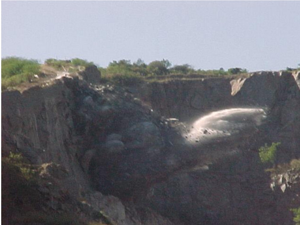
Figura 13 - Detonação em pedreira urbana no Rio de Janeiro, causando poeira, vibrações e ruídos.
