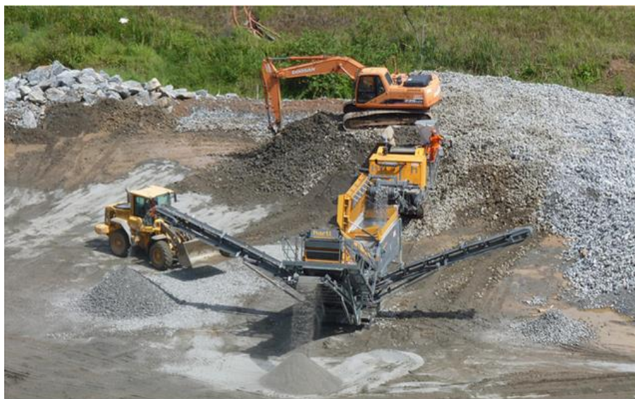
Figura 9: Rebritadores, fragmentam a rocha até o tamanho desejado. CRAFT Engenharia, 2013.
