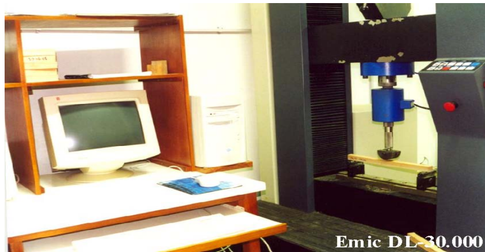
Figura 3 Máquina de ensaio universal (EMIC-30000).
