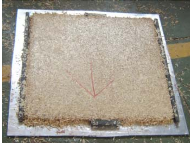
Figura 4 Marcação da frente de prensagem nos painéis aglomerados.
