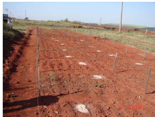
Foto 11 – Leitura da infiltração nos pontos com areia Foto 12 - Leitura da infiltração nos pontos com areia
