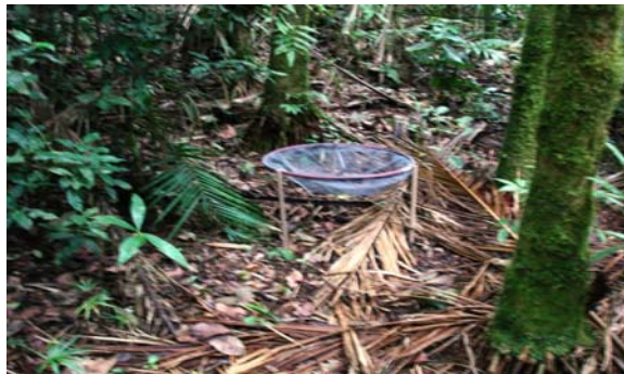
Figura 9 – Coletor de serapilheira instalado nas parcelas selecionadas para estudo de produção e estoque de serapilheira nas fitofisionomias (MARTINS, 2010)
