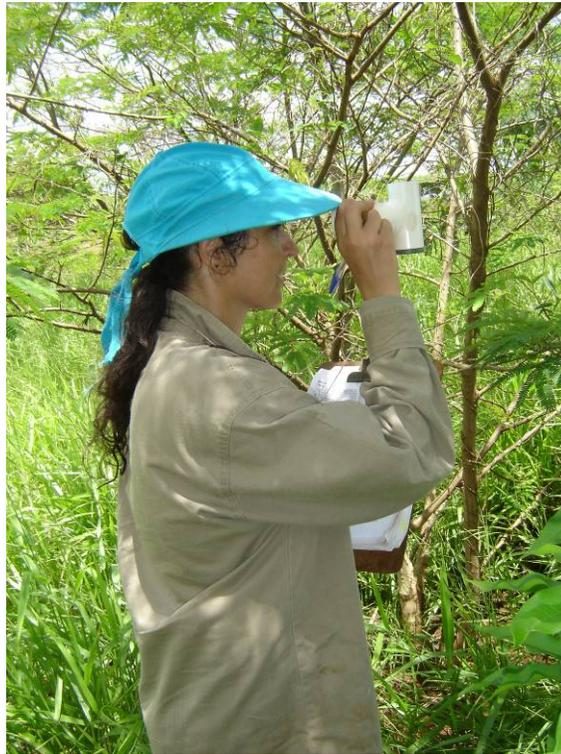
Figura 3.15 – Avaliação da cobertura de copas utilizando densitômetro vertical (GRS densitometer)
