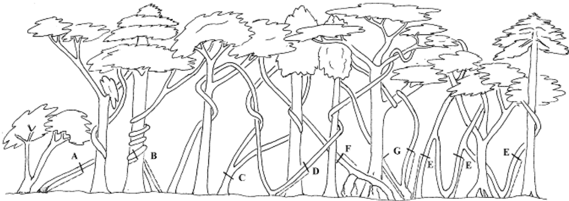
Figura 3 - Esquema indicando os pontos de mensuração do diâmetro das trepadeiras, pelo protocolo de GERWING et al. (2006)
