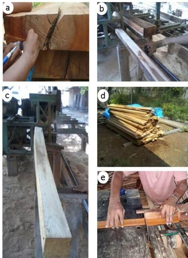
**Figura 4** - Desdobro dos pranchões em corpos-de-prova para ensaios mecânicos. a) Marcação dos pranchões para a obtenção de sarrafos com 5x5cm e do pranchão em pranchas com 2cm de espessura a serem retiradas na face tangencial e o mais distante da medula; b) Secção do pranchão com o auxílio de uma serra circular; c) Sarrafo com 5x5cm; d) Pranchas com 2cm empilhadas; e) Desdobro das pranchas em seções menores de 21x5x1cm (Comprimento x largura x espessura)
