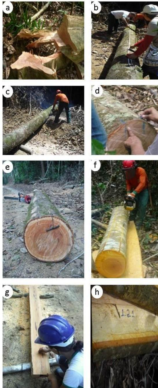
Figura 3 - Coleta de amostras. a) Toco de exploração; b) Mensuração para posterior desdobro em duas toras, cada uma com 2m de comprimento; c) Desdobro da árvore em toras; d) Mensuração de 10 a 15cm; e) Marcação da tora; f) Desdobro da tora em pranchões; g) Codificação das peças; h) Peça com codificação correspondente à espécie
