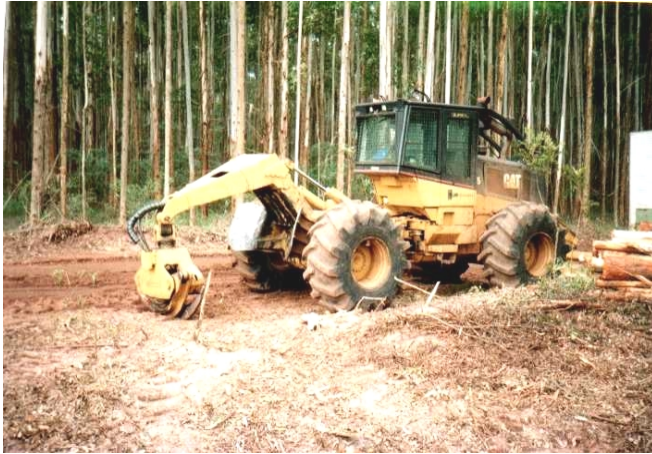
Figura 15 - Vistas lateral e traseira do Skidder estudado neste trabalho.
