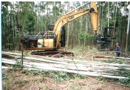
Figura 12 - Vista lateral do Feller-Buncher e vista frontal do cabeçote de corte.
