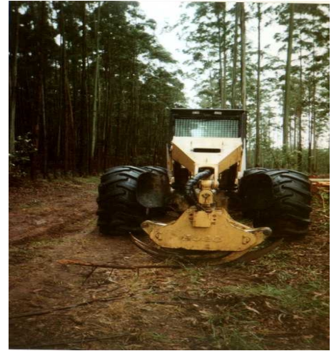
Figura 15 - Vistas lateral e traseira do Skidder estudado neste trabalho.
