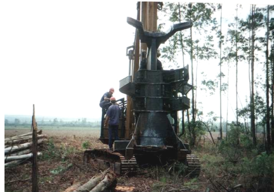
Figura 12 - Vista lateral do Feller-Buncher e vista frontal do cabeçote de corte.
