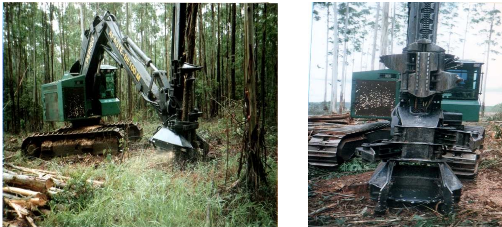
Figura 14 - Vistas lateral e frontal do conjunto máquina-base + cabeçote Slingshot.
