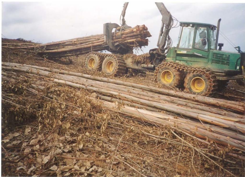
Figura 4 – Arraste da madeira realizado pelo Clambunk.
