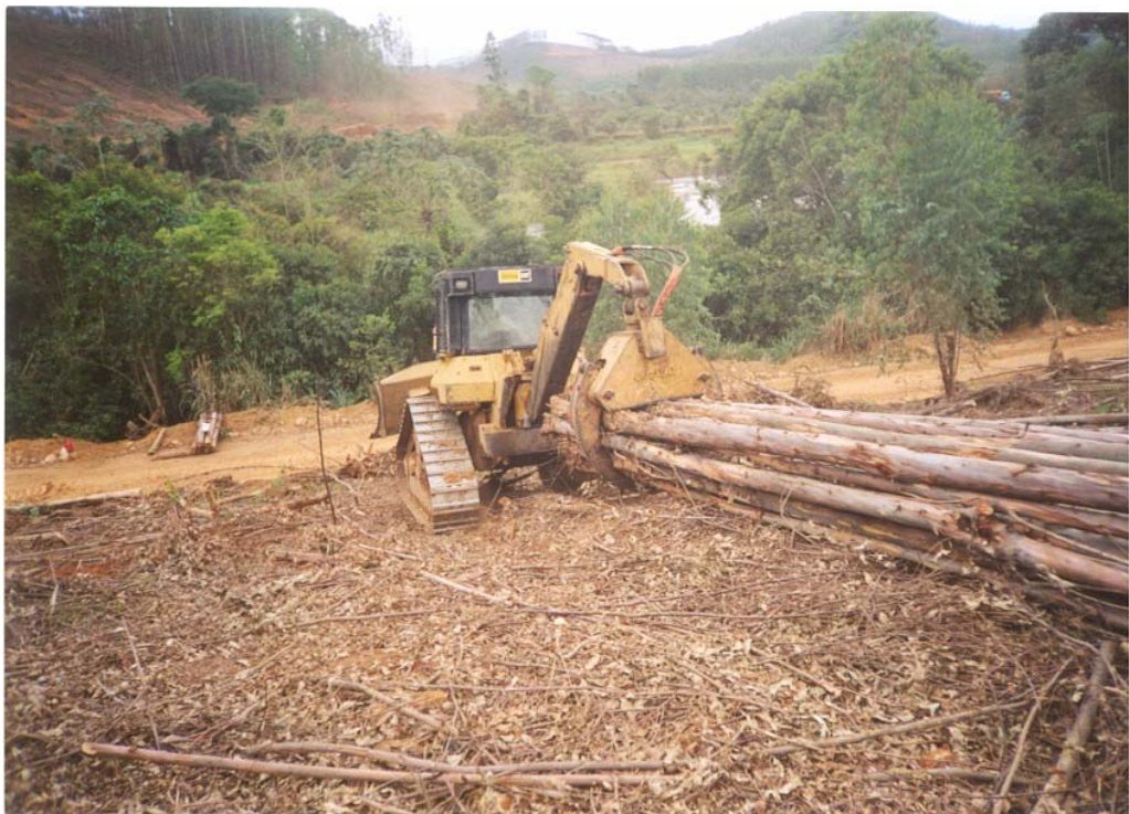
Figura 2 – Arraste da madeira realizado pelo Track Skidder.
