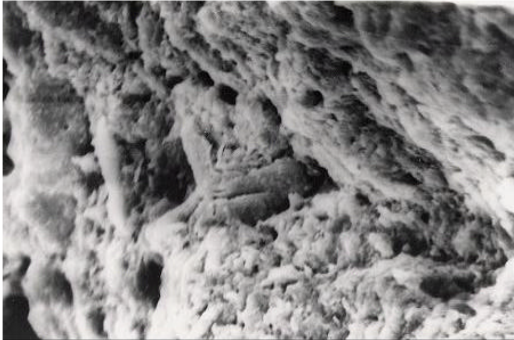
Figura 12A - Fotografia em microscópio eletrônico de varredura com aumento de 3500 vezes, ultradetalhe da orientação das partículas de argila sob raiz.
