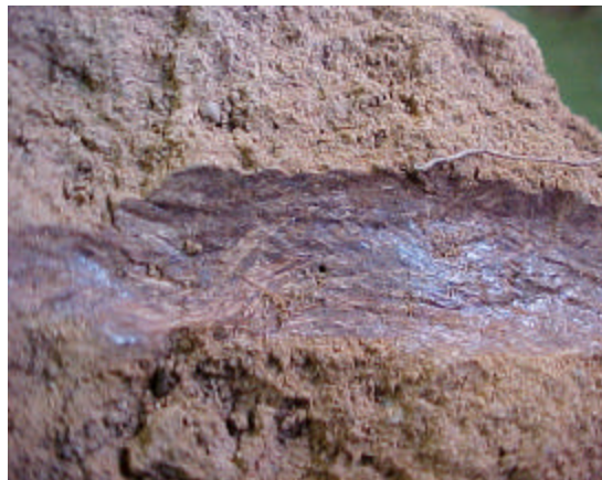
Figura 1A – Fotografias sob câmera digital de blocos compactados na interface solo-raiz.
