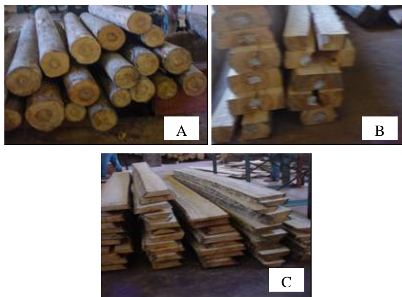
Figura 2 - Processamento primário das toras de paricá. A: Toras; B: Prancha diametral; C: Tábuas.
