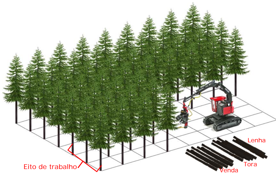
Figura 5 – Esquema do posicionamento da máquina no eito de trabalho
