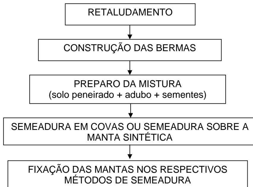
FIGURA 5 – Procedimentos para preparo do talude e aplicação dos tratamentos.
