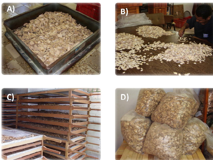
Figura 13 – Preparação dos cavacos para cozimento kraft e análises químicas: (A) peneiramento, (B) classificação manual, (C) secagem; (D) embalagem em sacos de polietileno.
