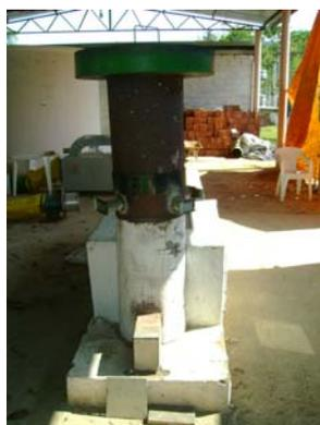
Figura 4: Reator do gaseificador.
