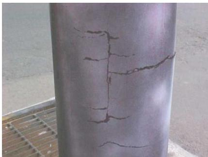
Figura 5.8: tubo central destruído por trincas de SCC (CENIBRA, 2003).
