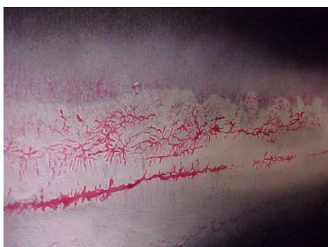
Figura 5.5: trincas de SCC na região de transição do digestor 1 (CENIBRA, 2003).
