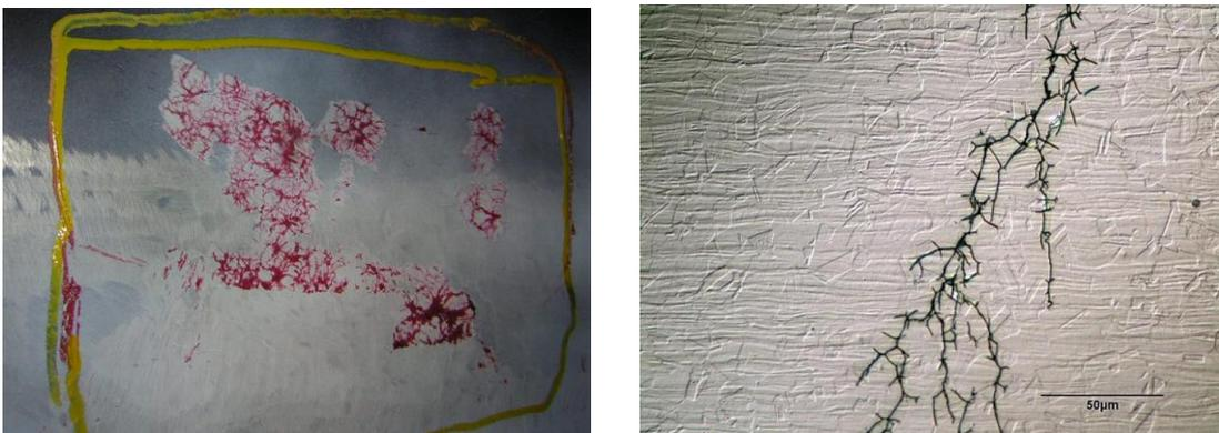
Figura 3.10: aspecto macrográfico (a) e micrográfico (b) da corrosão sob tensão fraturante (SCC) (CENIBRA, 2004; Wensley, 2006).
