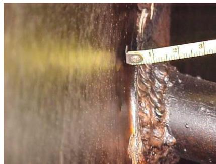
Figura 5.3: área com corrosão uniforme. Notar a perda de material junto à solda (CENIBRA, 2002).
