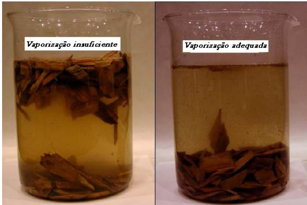
Figura 30: Incremento da densidade pela adequada vaporização do cavaco.
