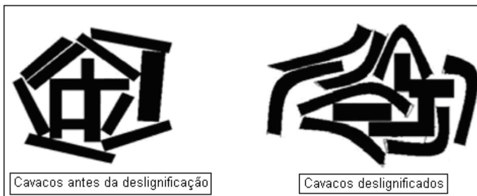
Figura 47: Representação esquemática da compactação de cavacos conforme evolução das reações de deslignificação (JANSSON et al. , 2008).
