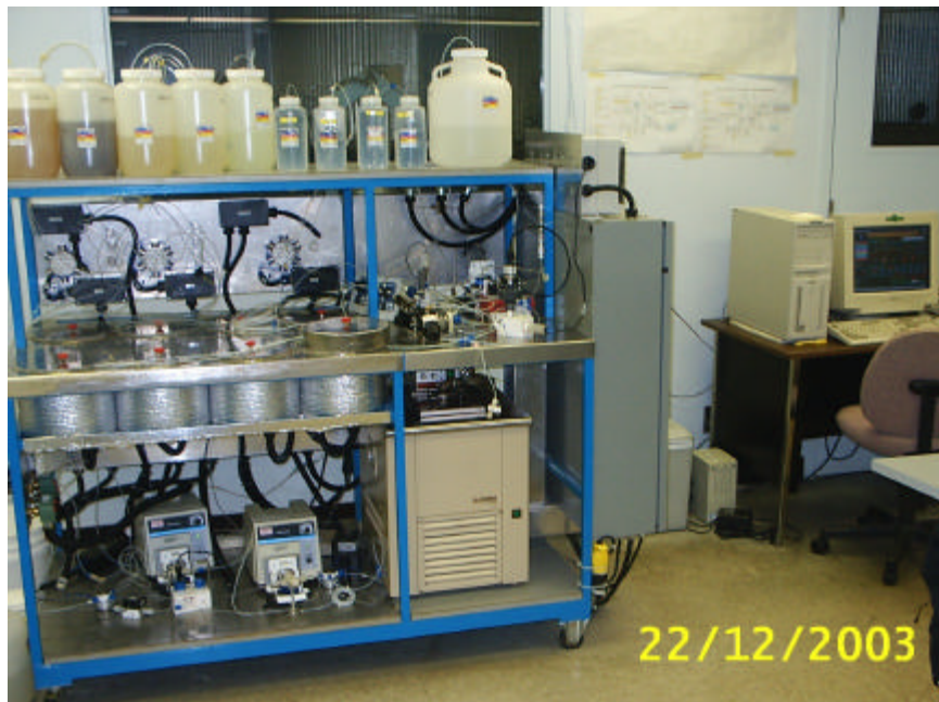
Figura 1 - Equipamento automatizado de branqueamento construído pelo Paprican.
