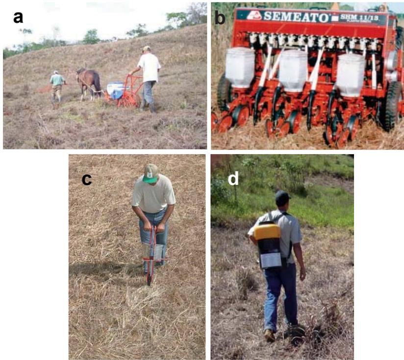
**Figura 3** - Plantadeira-adubadeira de plantio direto de tração animal (a), tratorizada para semeadura simultânea de milho com duas linhas de braquiária na entrelinha (b), matraca para plantio direto (c) e semeadora de forrageiras a lanço (d).
