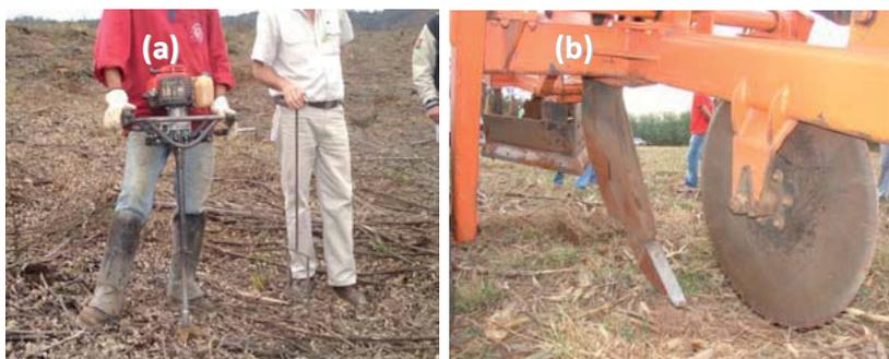
**Figura 3** – Abertura de cova com motocoveadora (a) e subsolador (b).
