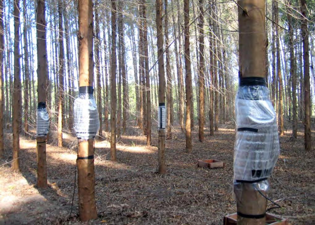
Processo de medição do fluxo de seiva no interior da árvore
