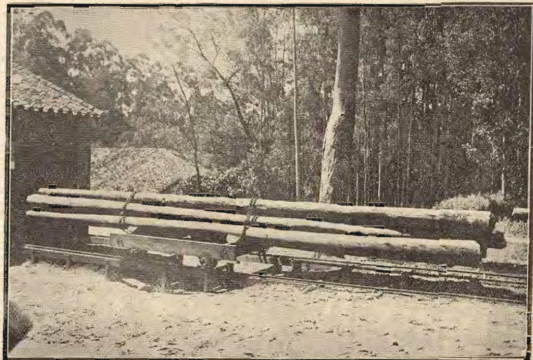
Fig. 65 — Lingada de postes preparados para o banho com carbolineo, no horto florestal de Rio Claro.
