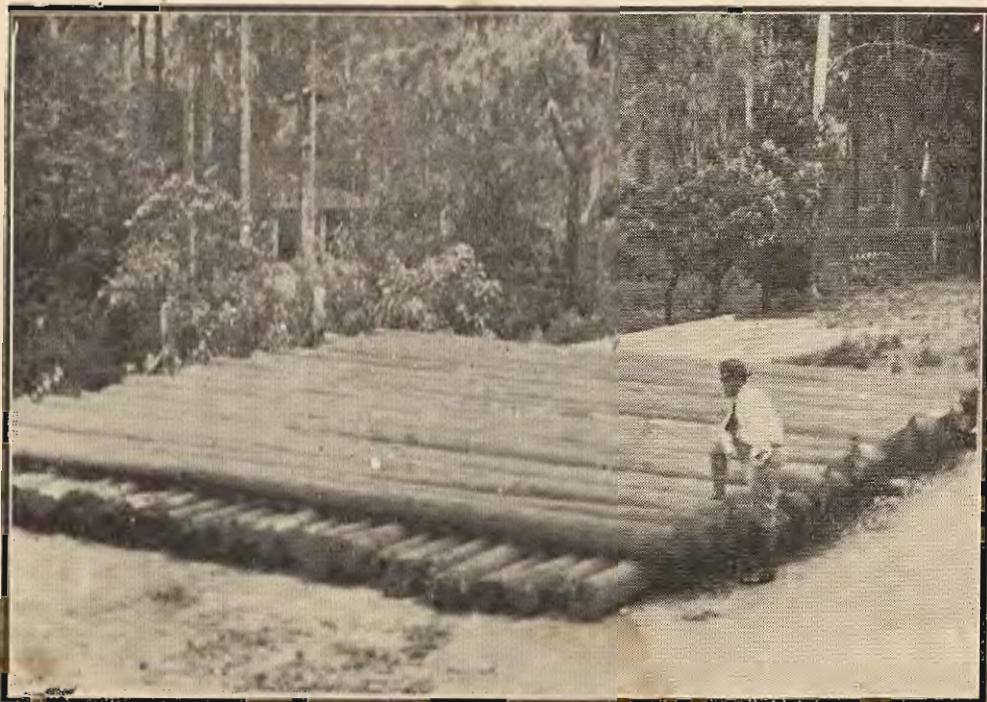
Fig. 64 — Postes de eucalipto tratados com carbolineo, no horto florestal de Rio Claro.
