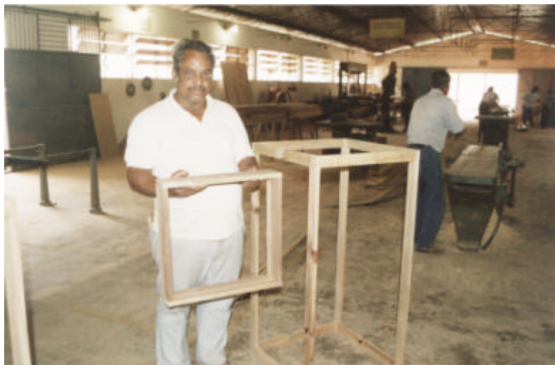
FIGURA 4: Estruturas construídas de madeira a serem cobertas por sombrite para proteção contra contaminação de propágulos.
