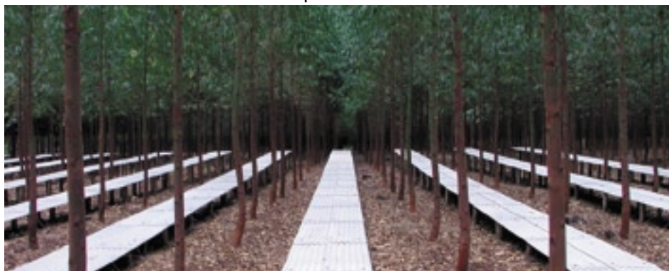
Parcela de Eucalyptus clonal, com 1.5 anos e com simulação de seca através do uso de telhas que removem 33% da precipitação normal, na Copener
