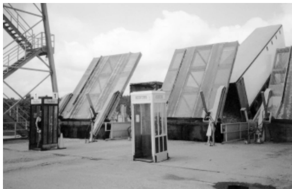
Descarregamento de cavacos por plataforma elevatória em pátio de fábrica de celulose
