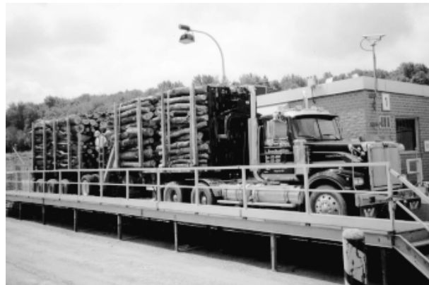
Pesagem de caminhão com carga no sentido longitudinal
