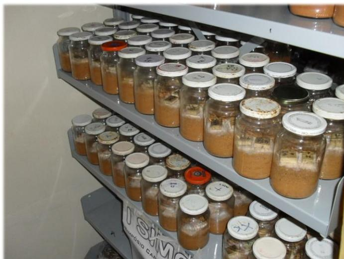
Figura 10. Ensaios acelerado de apodrecimento com fungos.
