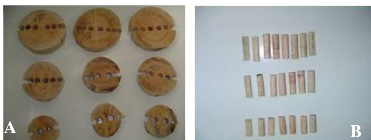
FIGURA 1 Esquema da retirada das amostras na amostragem radial nos discos a 1,30 m de altura do solo (DAP) em (A) e amostras (B) na madeira do clone de Eucalyptus grandis W. Hill ex Maiden x Eucalyptus urophylla S. T. Blake.
