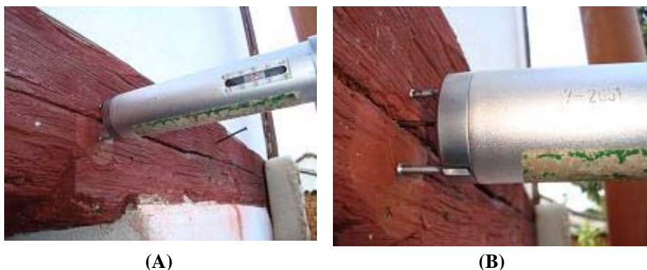
FIGURA 9 Pilodyn, sendo A: com destaque para a escala lateral; B: com destaque para o pino.
