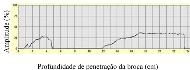
FIGURA 12 Forma de análise de um perfil de perfuração, sugerida por Freitas (2009).
