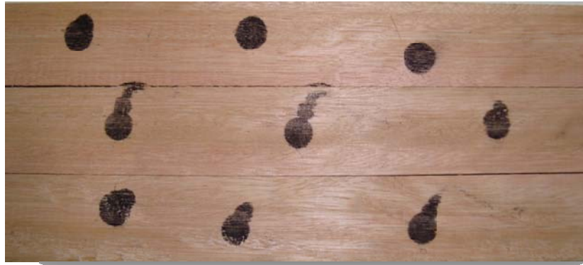
FIGURA 12 – Corpo-de-prova com depressões causadas pelo impacto da esfera de aço, realçadas pelo papel carbono.
