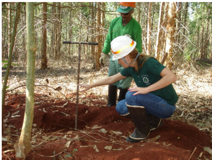
FONTE: BELINOVSKI (2010). FIGURA 12 - COLETA DE SOLOS NAS DIFERENTES PROFUNDIDADES. CAPÃO BONITO – SP.
