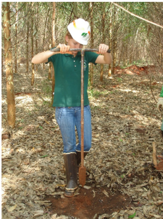
FONTE: BELINOVSKI (2010). FIGURA 13 - COLETA DAS AMOSTRAS DE SOLOS COM A UTILIZAÇÃO DE UM TRATO HOLANDÊS. CAPÃO BONITO – SP.
