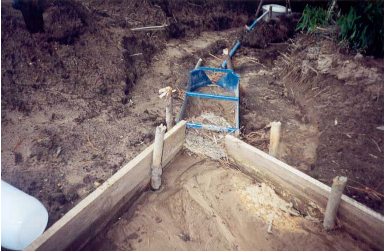
FIGURA 8 - DETALHES DA CALHA COLETORA DE SOLO, NO MOMENTO DA PRIMEIRA AMOSTRAGEM
