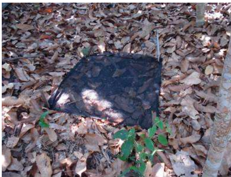
Figura 7: Coletor de folhas decíduas
