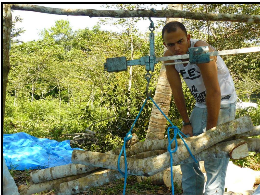
Figura 8 - Balança de braço para pesagem da biomassa fresca de cada compartimento. CAMES, Rod. AM-010, km 41 (Manaus-AM).
