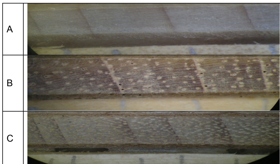
FIGURA10 -ANÉIS DE CRESCIMENTO AMPLIADOS COM USO DA LUPA LEICA STEREO ZOOM ACOPLADA À MESA DE MEDIÇÃO LINTAB 6, SENDO: A: Araucaria angustifolia ; B: Cedrela fissilis ; C: Ocotea porosa .AUMENTO 3 VEZES
