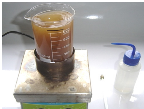
FIGURA 27 – AQUECIMENTO E AGITAÇÃO NA PREPARAÇÃO DAS SOLUÇÕES CONTENDO LIGNINA KRAFT E/OU AMIDO ANFÓTERO.
