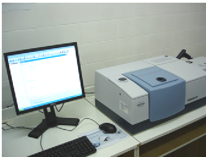
FIGURA 25 – EQUIPAMENTO UTILIZADO PARA AVALIAÇÃO DAS LIGNINAS POR ESPECTROSCOPIA NO INFRAVERMELHO.
