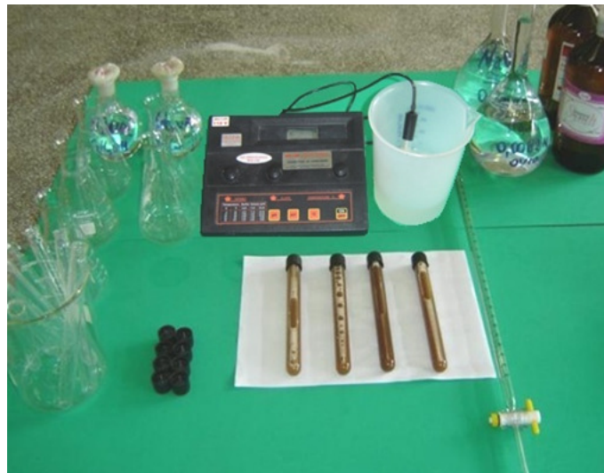
FIGURA 24 – EQUIPAMENTOS E MATERIAIS EMPREGADOS PARA DETERMINAÇÃO DO TEOR DE GRUPOS HIDROXÍLICOS NAS LIGNINAS.
