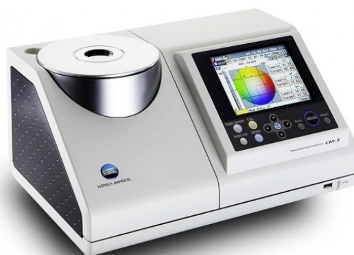
FIGURA 22 – EQUIPAMENTO UTILIZADO PARA AVALIAÇÃO COLORIMÉTRICA DAS MICROPARTÍCULAS DE LIGNINA KRAFT.
